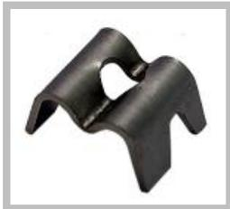
Для стыковки панелей используется клипса соединительная, выполненная из нержавеющей стали из расчета 4 шт. на панель шириной 2,5 м.
